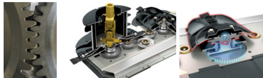
Der extrem robuste Mähbalken hat eine hohe Lebensdauer und erlaubt hohe Antriebskräfte. Große Antriebszahnäder mit 3,5 Zähnen im dauerhaften Eingriff.
